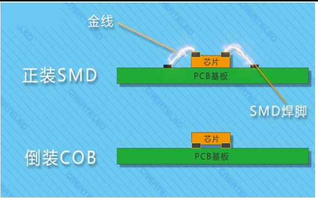
图 30：传统正装和倒装结构对比
