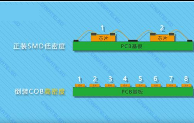
图 31：倒装可以实现 LED 高密度排列
