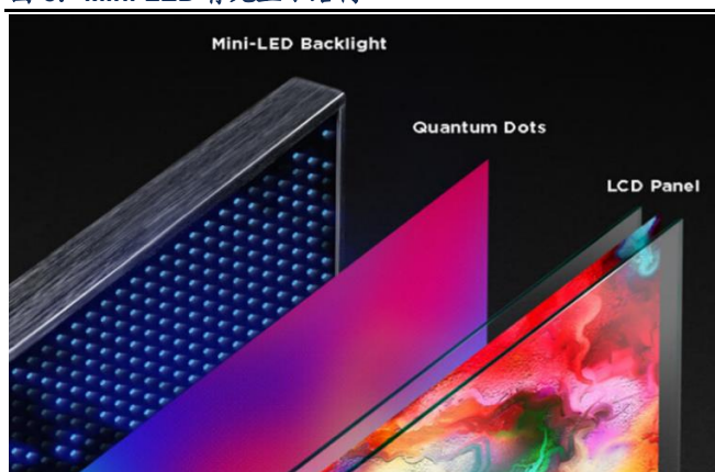
图 8：Mini LED 背光显示结构
