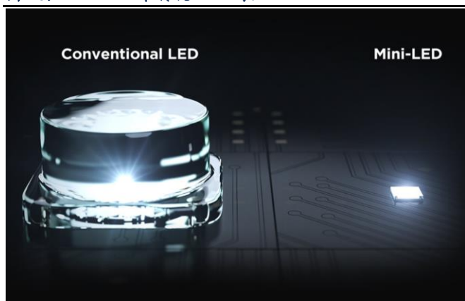
图 10: Mini LED 和传统 LED 对比
